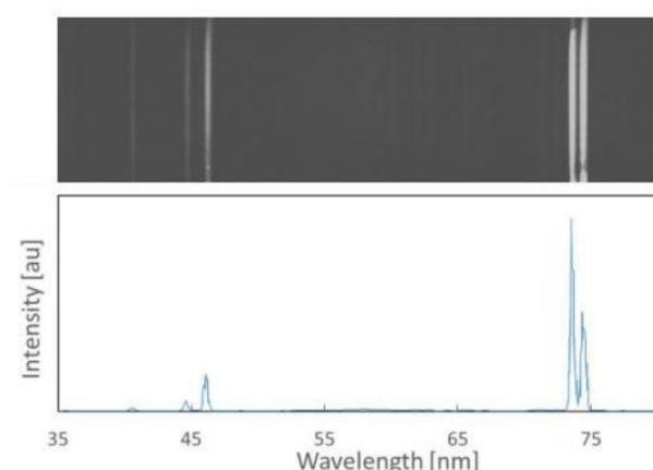
光栅效率转化为一阶衍射。由于专有的无狭缝技术，系统的总效率比传统的光谱仪高20倍。
