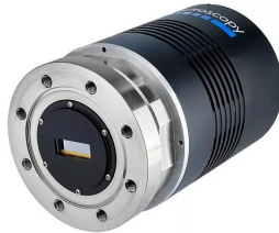
XUV CCD相机 (1-100 nm)
